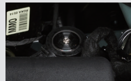
전자식 기화기 액체형태의 LPG가스를 기체상태로 변환하는 전자식 장치
