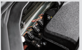
LPG 인젝터 엔진 인젝터에 LPG를 분사하는 장치
