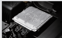
LPG ECU LPG전용 ECU로서 가솔린 ECU와 협업하여 2개 연료를 최적화
